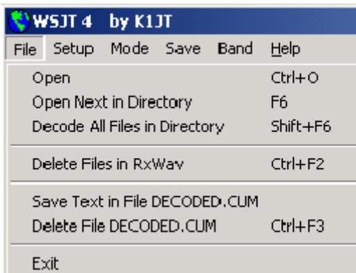
„Open“: lesen und dekodieren einer vorher gespeicherten Datei. Sie muß eine Standard-wave- Datei sein im 8-bit-Monoformat, mit 11025 Hz gesampelt.
